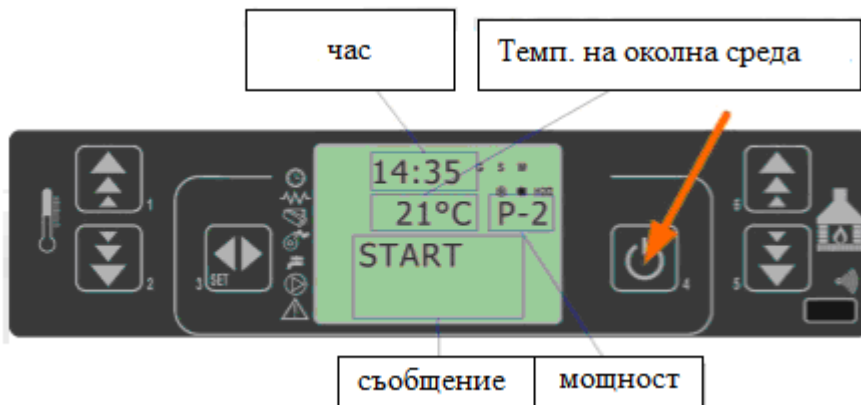
Фигура 5.1. Стартиране на работата на пелетната камина.
