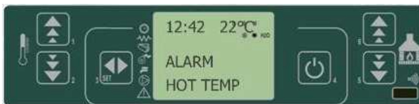
Фигура 7.2. Алармено съобщение за повишена температура на димните газове.
